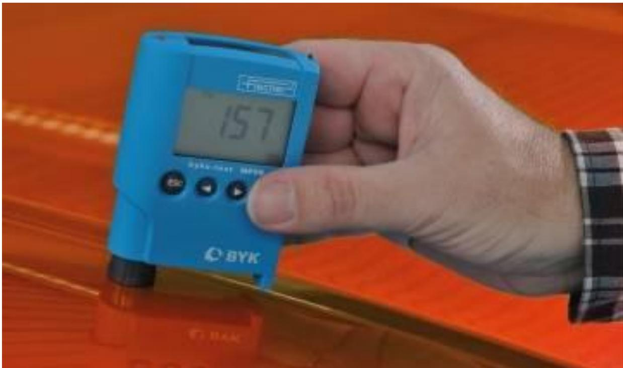
**Abbildung 3: Gezeigt wird ein Schichtdickenmessgerät im Einsatz bei der Messung der Lackdicke eines Autos. Dieses Gerät wurde auch zur Messung der Eloxal beschichteten Aluminiumrahmen verwendet. [7]**
